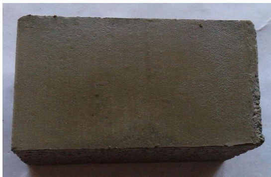
Рис. 2. Поверхность образца после эксперимента, изменения поверхности незаметны
