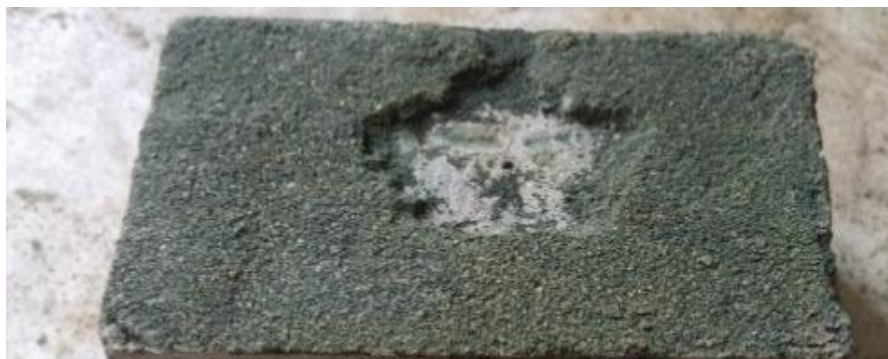
Рис. 2. Поверхность образцов после механического воздействия прокатывающего металлического ролика
