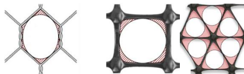
Рис. 1. Пятно контакта георешетки с различными формами ячейки
