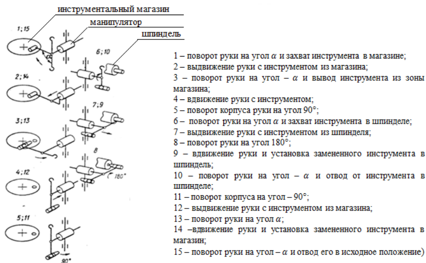
Рис. 1. Схема и алгоритм работы манипулятора последовательного действия
