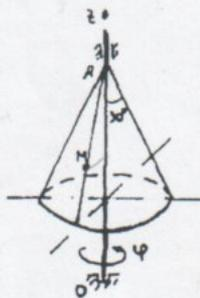
2. Конус, по образующей которого движется точка М согласно уравнению  $AM = 2t$  (м), вращается вокруг оси  $OZ$  по закону  $\varphi = 4 \sin 0,4t$  (рад). Определить модуль переносной скорости точки М в момент времени  $t_1 = 2$  с.
