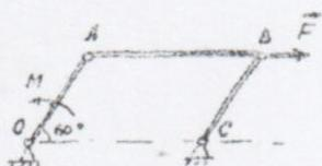
3. К стержню AB шарнирного параллелограмма OABC приложена горизонтальная сила  $F = 50$  Н. Определить модуль момента пары сил, которую необходимо приложить к кривошпицу OA длиной 10 см, для того чтобы уравновесить механизм.
