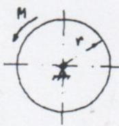
3. Однородный диск, масса которого  $m = 80$  кг и радиус  $r = 0,5$  м, вращается вокруг горизонтальной оси под действием пары сил с моментом  $M = 20t^2$  (Нм). Определить угловую скорость диска в момент времени  $t_1 = 6$  с, если его начальная угловая скорость  $\omega_0 = 0$ .
