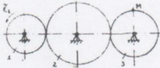
2. Зубчатое колесо 1 вращается равноускоренно с угловым ускорением  $\varepsilon_1 = 4$  рад/с<sup>2</sup>. Определить скорость т. М в момент времени  $t_1 = 2$  с, если радиусы зубчатых колёс  $R_1 = 0,4$  м,  $R_3 = 0,5$  м. Движение начинается из состояния покоя.
