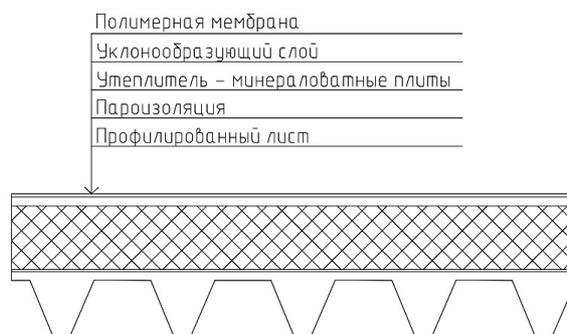
**Рис. 2. Пример конструктивного решения настилов бесчердачных покрытий, выполненных на основе стального профилированного листа, с пределом огнестойкости RE 15**
