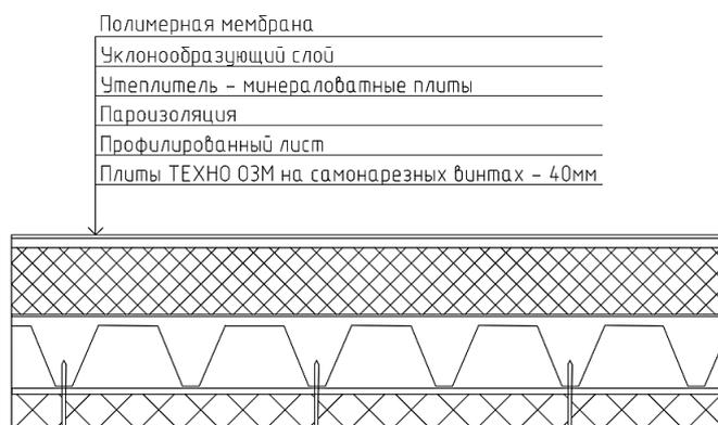
**Рис. 1. Пример конструктивного решения настилов бесчердачных покрытий, выполненных на основе стального профилированного листа, с пределом огнестойкости RE 30**
