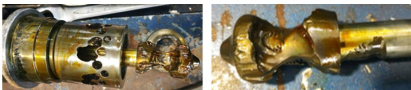
**Рис. 1. Последствия воздействия гидродинамической кавитации [2]**
