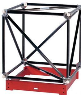
**Рис. 1. Эталон для калибровки и поверки КИМ типа "рука" "КОВА-Sphere beam"**
