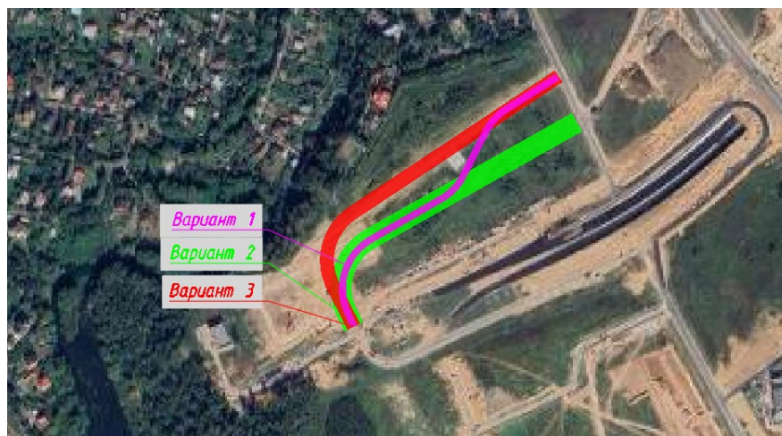
Рис. 2. Предлагаемые варианты трассировки автомобильных дорог
