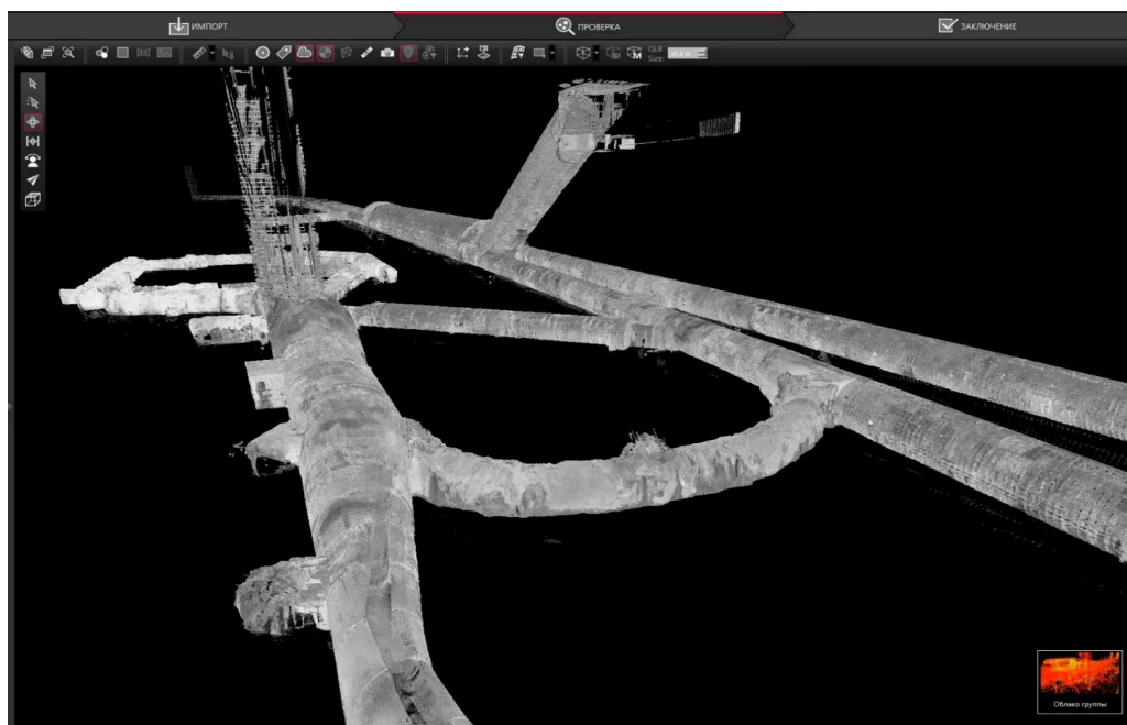
Рис. 4. 3D-модель узла разветвления тоннелей по данным лазерного сканирования (вид сверху) [23]
