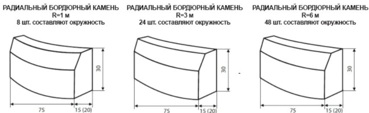
Рис. 2. Пример параметрического бордюрного блока с изменяемым радиусом [5]
