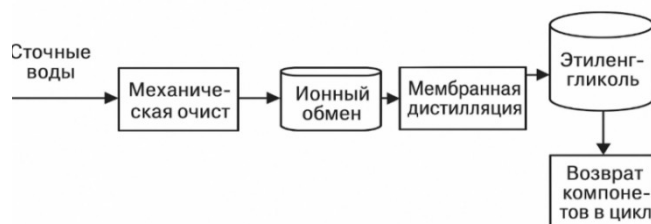
Рис. 1.Схема очистки сточных вод с выделением этиленгликоля
