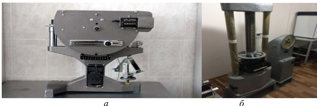
Рис. 1. Общий вид машины МИИ-100 для испытаний гипсовых композитов на изгиб (а) и гидравлический пресс П-50 (б)
