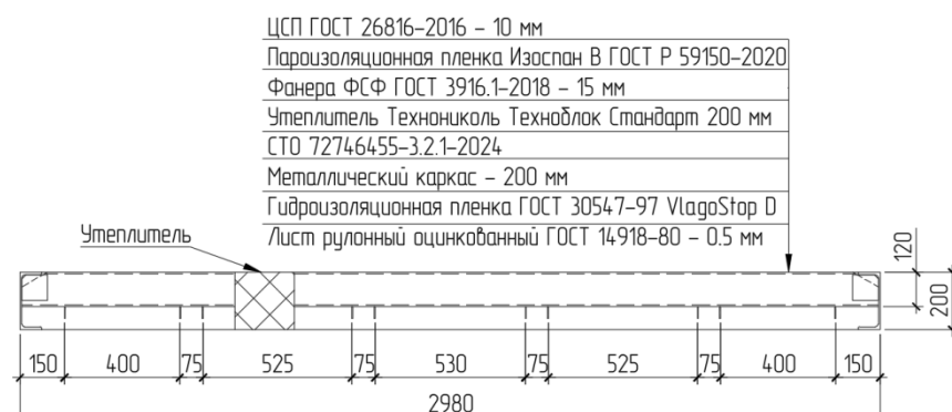
Рис. 5. Отделка панели основания
