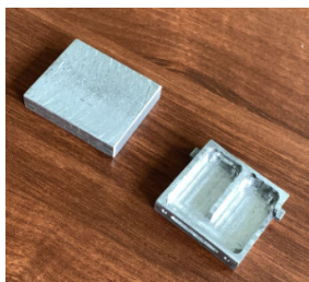
Рис. 5. Макет заготовки до слесарной обработки (а), готовые макеты заготовки и детали (б)
