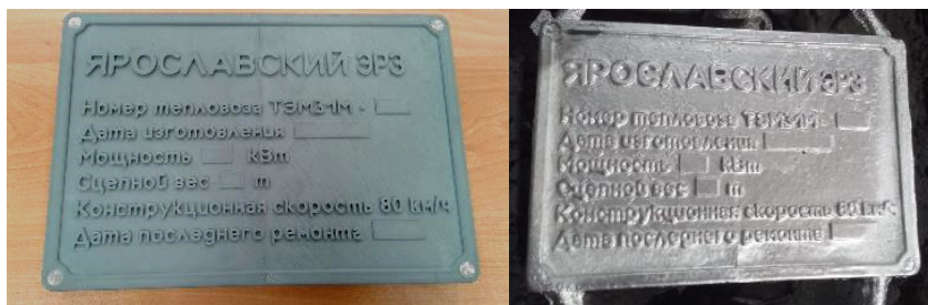
Рис. 1. Модель и алюминиевая отливка таблички тепловоза ТЭМ31М
