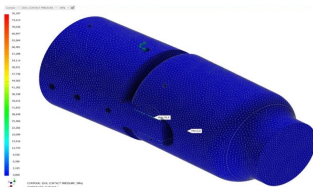
Рис. 2. Результаты расчета контактных давлений между вкладышем и лопастью шпиндельного устройства
