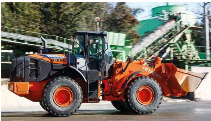
**Рис. 15. Гибридный фронтальный погрузчик Hitachi ZW220HYB-5B**
