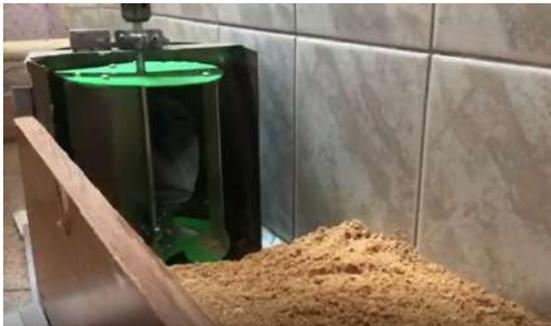
**Рис. 2. Экспериментальная установка для исследования работы вертикального питателя (вид сбоку)**
