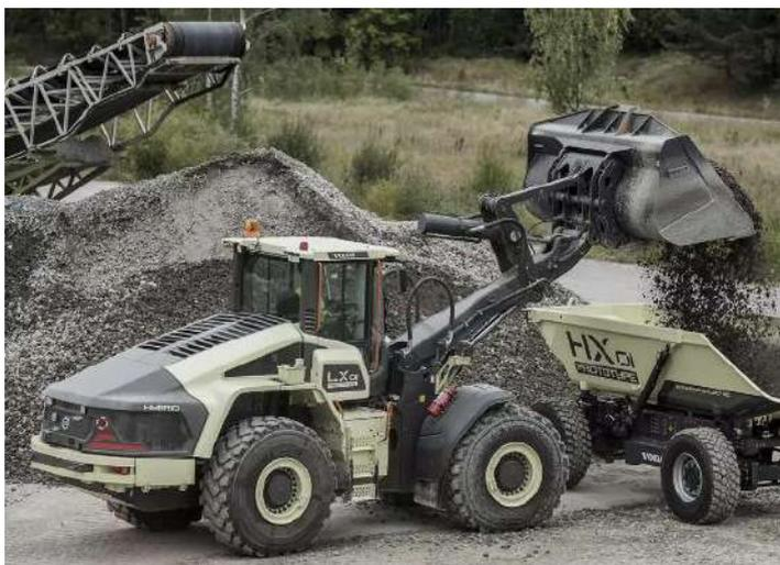
**Рис. 7. Гибридный фронтальный погрузчик Volvo LX1**
