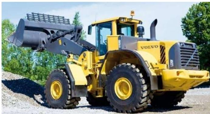
**Рис. 5. Гибридный фронтальный погрузчик Volvo L220F Hybrid**
