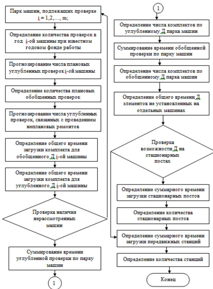
Рис. 2. Блок-схема алгоритма оснащения организаций проверочным оборудованием
