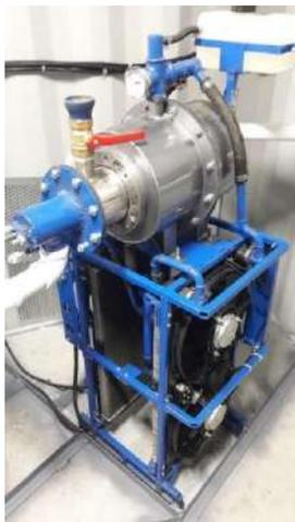
**Рис. 1. Аппарат вихревого слоя с перекрещивающимися магнитными полями**
