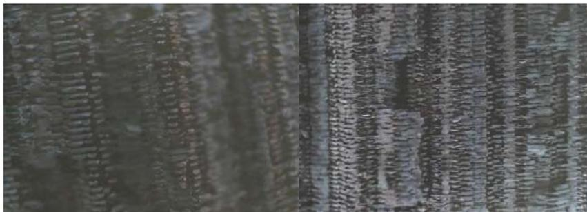
**Рис. 3. Фото области разлома серия образцов № 1:**
