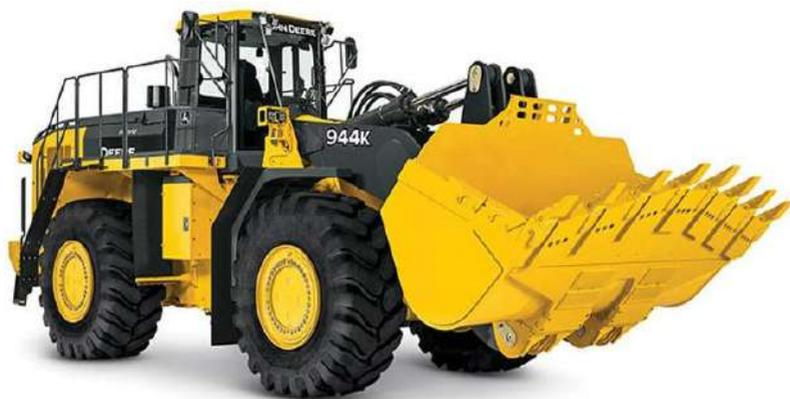
**Рис. 11. Гибридный фронтальный погрузчик John Deere 944К**
