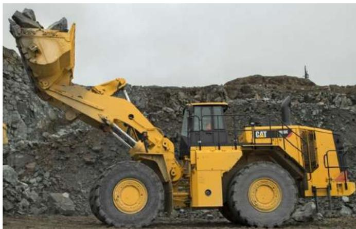
**Рис. 13. Гибридный фронтальный погрузчик Caterpillar 988К ХЕ**
