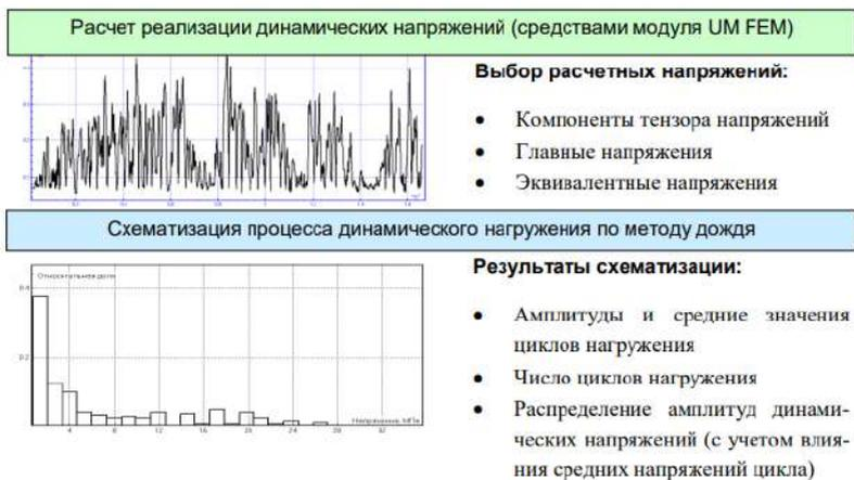
Рис. 16. Этапы анализа динамической нагруженности для частного режима эксплуатации
