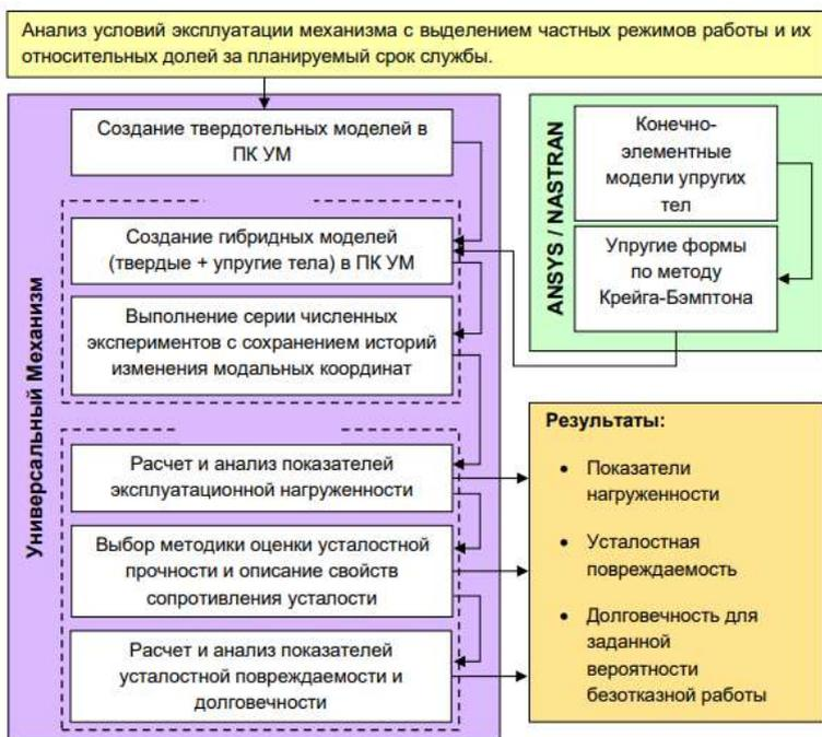
**Рис. 14. Краткая схема расчёта нагруженности и усталостной долговечности**
